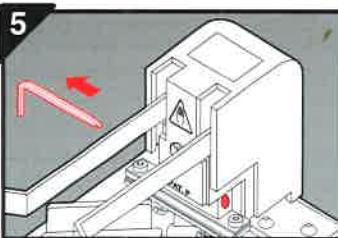
輕壓下把手，將一字型六角板手取出，放開把手，即完成換刀及校正側板工作。
