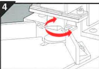
機台應隨時裝有塑膠墊，以保護刀具之刀口，為增加塑膠墊使用次數，所以當塑膠墊被刀具切割到無法再切斷紙張時，請用一字型六角板手輕輕的旋轉塑膠墊（如圖示方向），換個新位置就可再使用。
