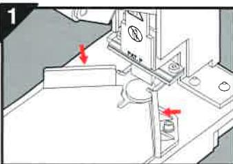
將兩側板向內推到緊靠工作台面兩邊，再用圓頭六角板手將固定螺絲鎖緊。
